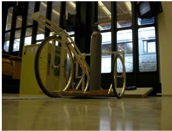
une bombonne de CO 2 est placée sur un chariot. Le professeur s'assied sur le chariot, ouvre la bouteille et s'en va ainsi...
