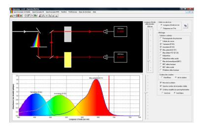
Donne le spectre d'absorption de différentes solutions avec la possibilité d'afficher le schéma simplifié du spectrophotomètre. Un curseur permet de sélectionner une longueur d'onde, ou de balayer toute les longueurs d'onde en déplaçant le curseur. On peut ainsi visualiser ce qui se passe dans le spectrophotomètre en lien avec la valeur de l'absorbance mesurée.
