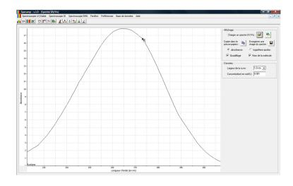
Charger un spectre, il s'affiche à l'écran. Un curseur permet de faire des mesures de longueur d'onde. Il est possible de changer la largeur de la cuve, la concentration de la solution étudiée. Après avoir ouvert deux spectres différents, le spectre résultant s'affiche. Il est possible de changer la largeur de la cuve, la concentration de la solution étudiée.
