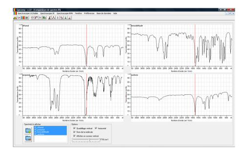
Pour l'initiation à l'étude des spectres IR et visualiser les bandes les plus caractéristiques/ Charger un spectre IR. Le curseur du bas permet de déterminer le nombre d'onde de chaque bande d'absorption. Un tableau donne ces nombres d'ondes.
