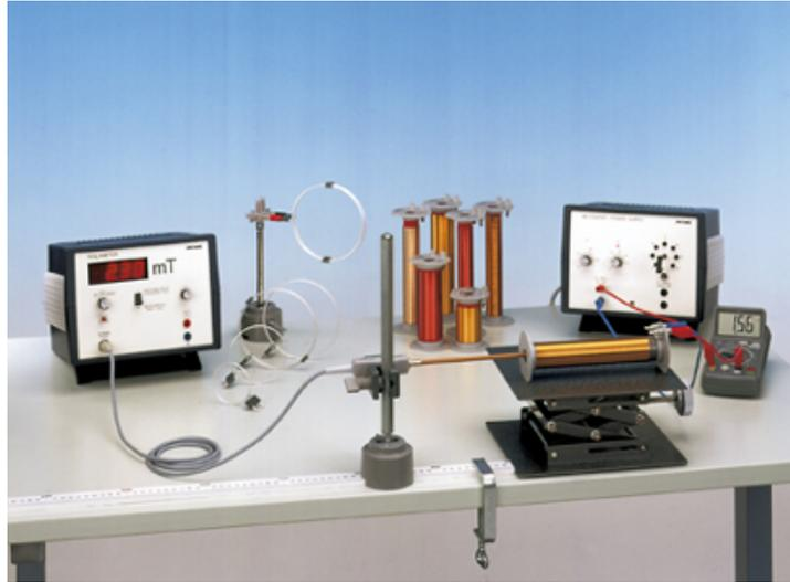
On mesure le champ magnétique au centre d'une bobine, à l'aide d'un teslamètre, pour différentes valeurs de courant qui circule dans celle-ci. Avant toutes mesures, il faut étalonner le teslamètre. Pour cela on place la sonde éloignée de tout champ magnétique et on règle le teslamètre de façon à ce qu'il affiche 0 mT. On effectue les mesures et on trace  $B = f(I)$  grâce à un teslamètre muni d'une sonde à effet Hall.
