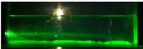
Protocole : Placer le laser de sorte que le faisceau entre au plus bas de la face de l'aquarium et montrer que le faisceau lumineux ne se propage pas en ligne droite, sa trajectoire se courbe vers le bas.
