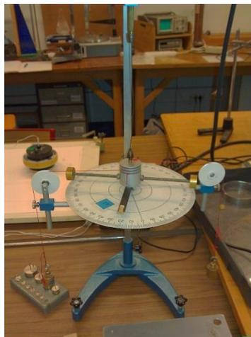
Détermination de la constante de torsion :
