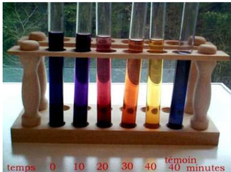
Résultats avec le test à l'eau iodée. Le changement de coloration met ici bien évidence les composés intermédiaires notamment les dextrines colorées en rouge bordeaux par ce réactif.
