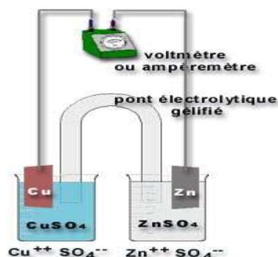
A l'anode il se passe l'oxydation du zinc  $\text{Zn(s)} = \text{Zn}^{2+} + 2 \text{e}^-$
