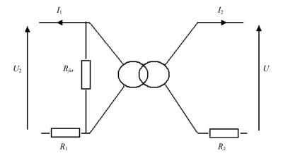
La valeur de la résistance  $R_{fer}$  est donnée par l'inverse de la pente donnant les pertes fer en fonction de la tension d'alimentation.
