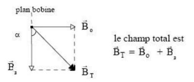
L'aiguille aimantée subit un couple de torsion  $\vec{\tau} = \vec{M} \times \vec{B}$  qui tend à l'orienter dans le sens de  $\overrightarrow{B_T}$ . A l'équilibre, on a  $\tan \alpha = B_o/B_a$  soit  $B_a = \mu_0 NI/(2R \tan \alpha)$
