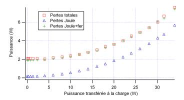
Les pertes fer sont donc indépendantes de la résistance de charge. On peut donc modéliser le transformateur par le schéma suivant.
