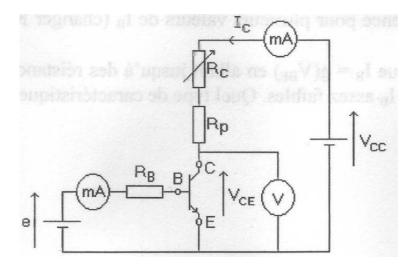
Le schéma est donné ici, avec  $e=10~\rm V$ ,  $V_{cc}=15~\rm V$ . On relève dans un premier temps la caractéristique  $I_c=f(V_{ce})$  en faisant varier  $R_C$ . On se débrouille pour se placer sur un point de fonctionnement situé en régime linéaire (caractéristique presque horizontale) et ensuite, on fait varier  $R_B$  pour accéder au coefficient d'amplification du courant  $\beta$ .
