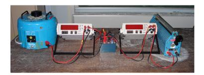
Mesures : On peut déjà mettre en évidence l'abaissement de la tension efficace entre le primaire et le secondaire en relevant sur les wattmètres  $U_1$  et  $U_2$ . C'est le rôle principal du transformateur. Le rapport de ces tensions nous donne le rapport de transformation m du transformateur.
