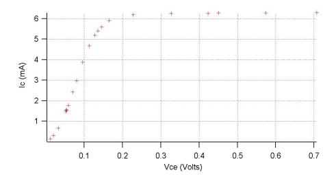
On trouve  $\beta=156,\,0\pm0,\,2$ . Cependant, cette valeur n'est valable qu'à ce point de fonctionnement, avec ce type de montage, etc. D'ailleurs, selon le constructeur,  $\beta$  est compris entre 100 et 300, sans plus de précision. Ainsi, ce fait doit être précisé : cette valeur n'a pas d'intérêt pour la suite, et le fonctionnement du push-pull ne dépend pas de  $\beta$  (du moment qu'il soit suffisamment élevé).
