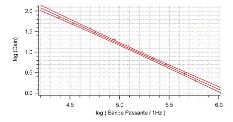
On trouve comme résultat de la régression linéraire  $\log(Gain) = b \log(BP) + a$ , avec  $b = -1,10\pm0,06$  et  $a = 6,12\pm0,32$ , c'est à dire  $GBP \simeq 10^6$  Hz, le b = 1 mesurant l'écart à cette loi. On voit donc que notre montage inverseur se comporte en réalité comme un
