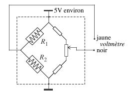
Il s'agit d'illustrer une application des jauges de contrainte au moyen de la partie mécanique d'une balance électronique Les deux jauges de contrainte sont collées sur le bâti et mesurent ses déformations : si l'une des jauges s'allonge, sa résistance augmente (attention : dans la formule  $R = \rho L/s$  les trois paramètres  $\rho, L$  et s varient, tous agissant dans le même sens sur la résistance).
