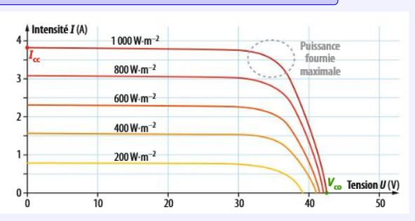
La caractéristique I = f(U) de la cellule photovoltaïque dépend de la puissance lumineuse reque. Dans la partie horizontale, la cellule se comporte comme un générateur de courant. L'intensité de court-circuit  $I_{cc}$  correspond à l'intensité du courant lorsque les deux bornes de la cellule photovoltaïque sont reliées par un fil conducteur (elles sont alors en court-circuit)
