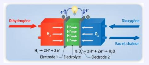
La pile à hydrogène est constituée de deux électrodes, séparées par un électrolyte qui permet le passage des ions.
