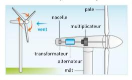
On a relevé ci-contre les valeurs annuelles, en MWh, des énergies qui interviennent dans la chaîne énergétique d'une éolienne.
