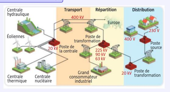
L'énergie électrique ne se stocke pas et sa production doit être adaptée à la consommation des utilisateurs.
