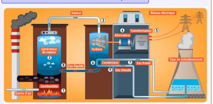
La combustion du charbon, du fioul, etc. produit de l'énergie thermique, ce qui permet de vaporiser l'eau.
