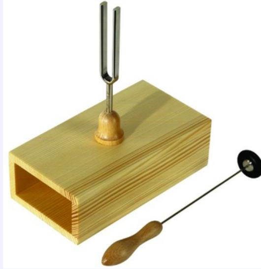
Les branches en métal vibrent et émettent un son à une fréquence étalonnée, en général la note La<sub>3</sub>, note de référence mondialement acceptée. Ce son peut être amplifié si l'on pose la base du diapason sur une cavité résonnante, comme la caisse d'une guitare ou sur une table.
