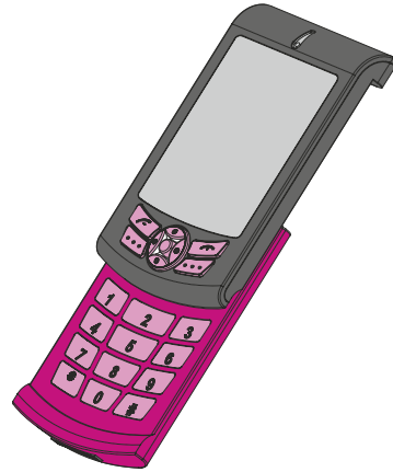
Figure 4.19 Exemple de liaison glissière : un téléphone portable dont la partie supérieure coulisse sur la partie inférieure.
